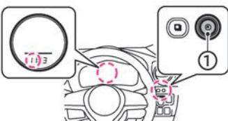
**2** 点滅している間に時計調整スイッチ①を押し、「時」を調整します。
