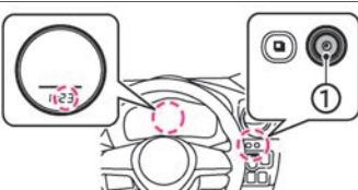
**3** 点滅している間に時計調整スイッチ①を押し、「分」を調整します。
