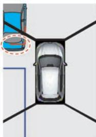
駐車枠線が引いてある駐車場の場合は、車両が停車すると自動で駐車目安枠(青色)を微調整します。
