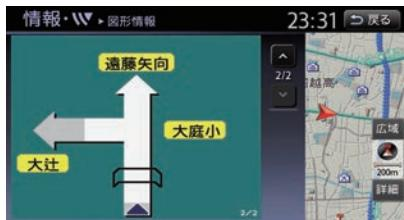
光ビーコンは主に進行方向の一般道路と高速道路の、渋滞・リンク旅行時間・規制・駐車場情報・区間旅行時間などを表示します。
