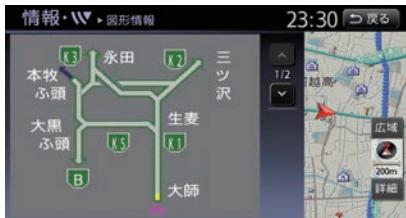
電波ビーコンは主に進行方向の高速道路の情報やインターチェンジ付近の接続道路、平行する一般道路の、渋滞・リンク旅行時間・規制・障害情報・SA/PA情報・簡易図形などを表示します。
